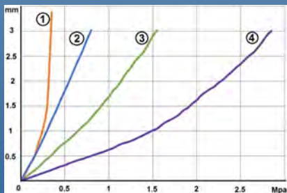
因法兰变形测量罐的总延伸率与压力的对比（在直径100mm，304L不锈钢板1.2mm厚的罐上进行测试）
